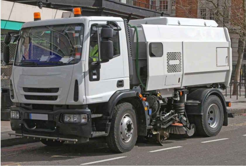
Balayeuse pour nettoyage de la chaussée
